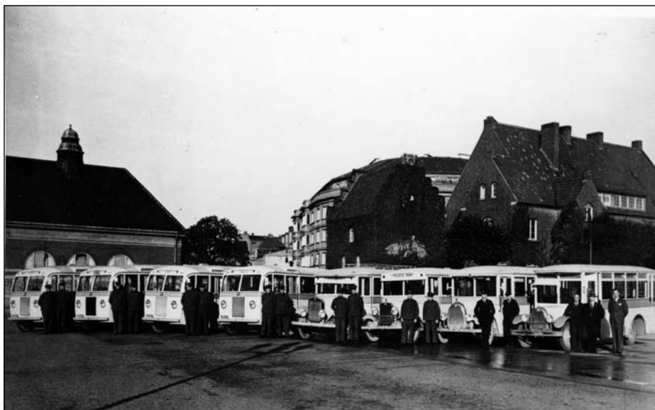
På bilden från Mårtenstorget ser vi åtta bussar som alla är målade i den nya gulvita och gröna färgsättningen. Bussarna är från vänster; M2207 (7), M2106 (6), M2405 (5), M1204 (4) samtliga nya Scania-Vabisbussar av modell 1544 med kaross från Hägglund & Söner. Sedan följer M1520 (3), M7541 (2), M14910 (1) och en av de fem små Tidaholmsbussarna med okänt registreringsnummer.
